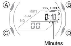
5. Utilisez les boutons (B) et (D) pour modifier le réglage des minutes.
