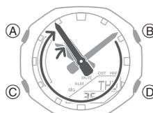
2. Pour replacer les aiguilles dans leur position d'indication de l'heure normale, appuyez de nouveau sur (B) et (C) simultanément.
