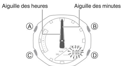
3. Si l'aiguille des heures et l'aiguille des minutes ne se trouvent pas sur 12 heures, utilisez les boutons (B) et (D) pour les aligner.
