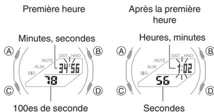
3. Appuyez sur le bouton (A) pour réinitialiser le chronomètre à zéro.
